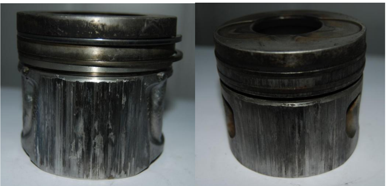
Fig. 4. A piston skirt seizure
